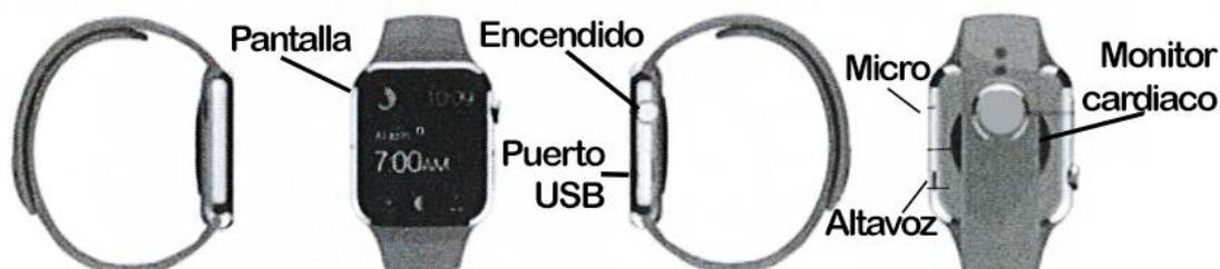
Botón encendido: para encender/apagar el reloj, encender la pantalla de modo reposo, apagarla, volver al menú de inicio.
